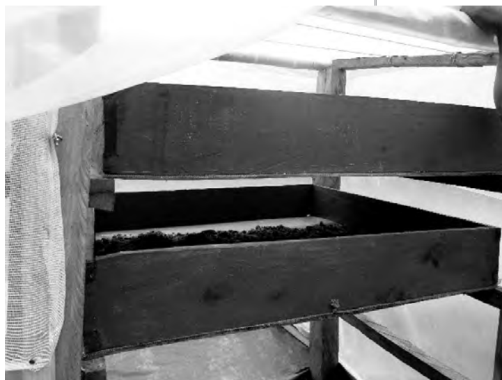
Distribución de las bandejas en la torre de secado del deshidratador.
