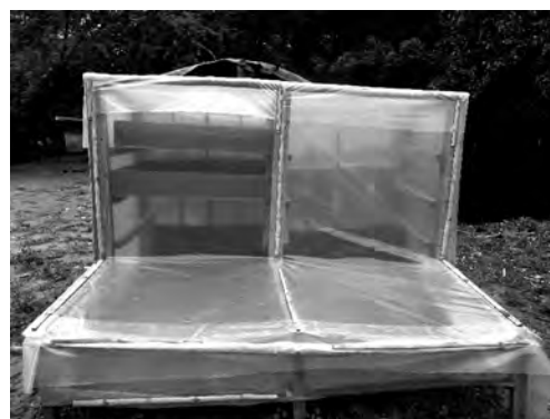
Modelo de deshidratador solar: Bandejas y puertas.
